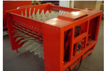
Apparato completo a raggi vibranti per la separazione della pianta
